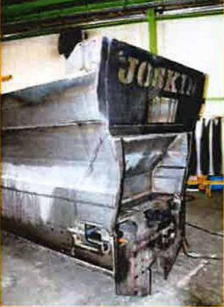
Een Tornado3 stalmeststrooier vóór het verven
