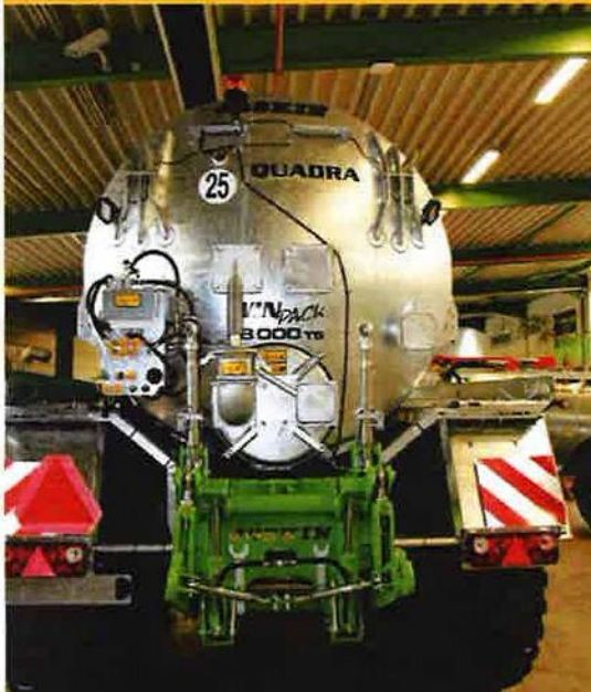
De 4-punteshifinrichting aan de achterzijde en de montagepunten boven de tank zijn voorafuitrustingen voor een achterwerktuig, zoals een sleepslangenboom.
