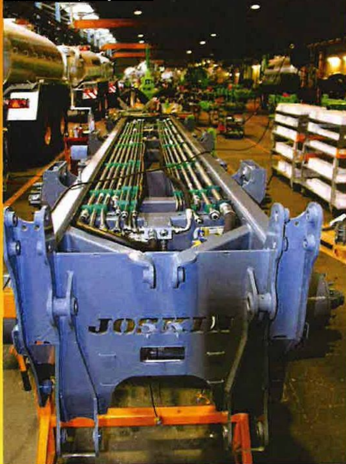
Een Euroliner chassis wordt uitgerust alvorens de tank erop wordt gemonteerd
